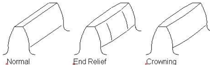
Figura 2.7 Modificação dos flancos dos dentes na direção na direção da largura
